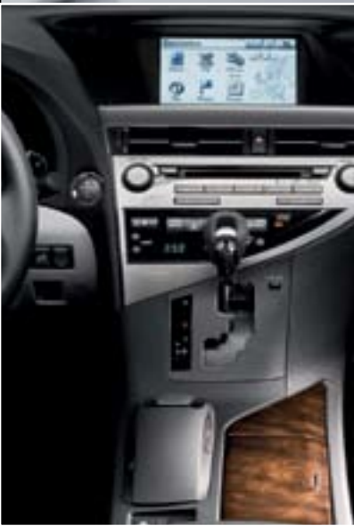
Самые интересные новшества в RX450h – джойстик управления «Remote touch» (слева и внизу) и приборная панель на ветровом стекле, на которую выводятся основные показатели управления автомобилем
